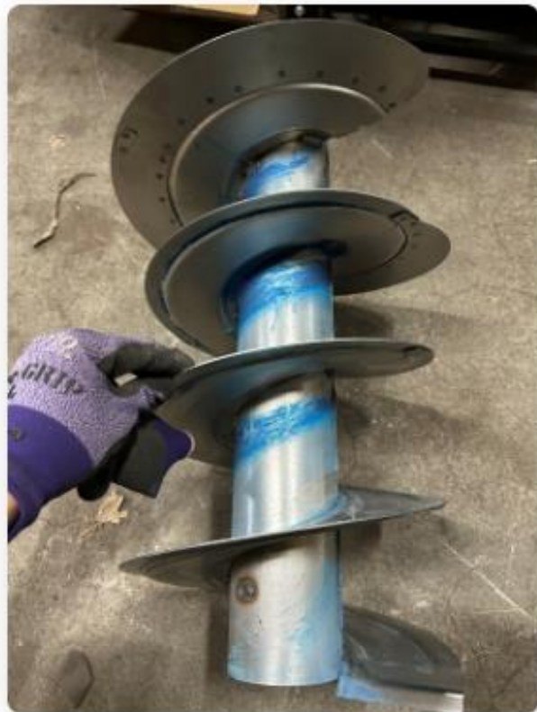
取り外したブレードを清掃
